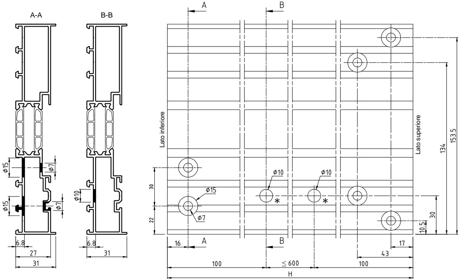
\* Fori per fissaggio profilato SC9A100
